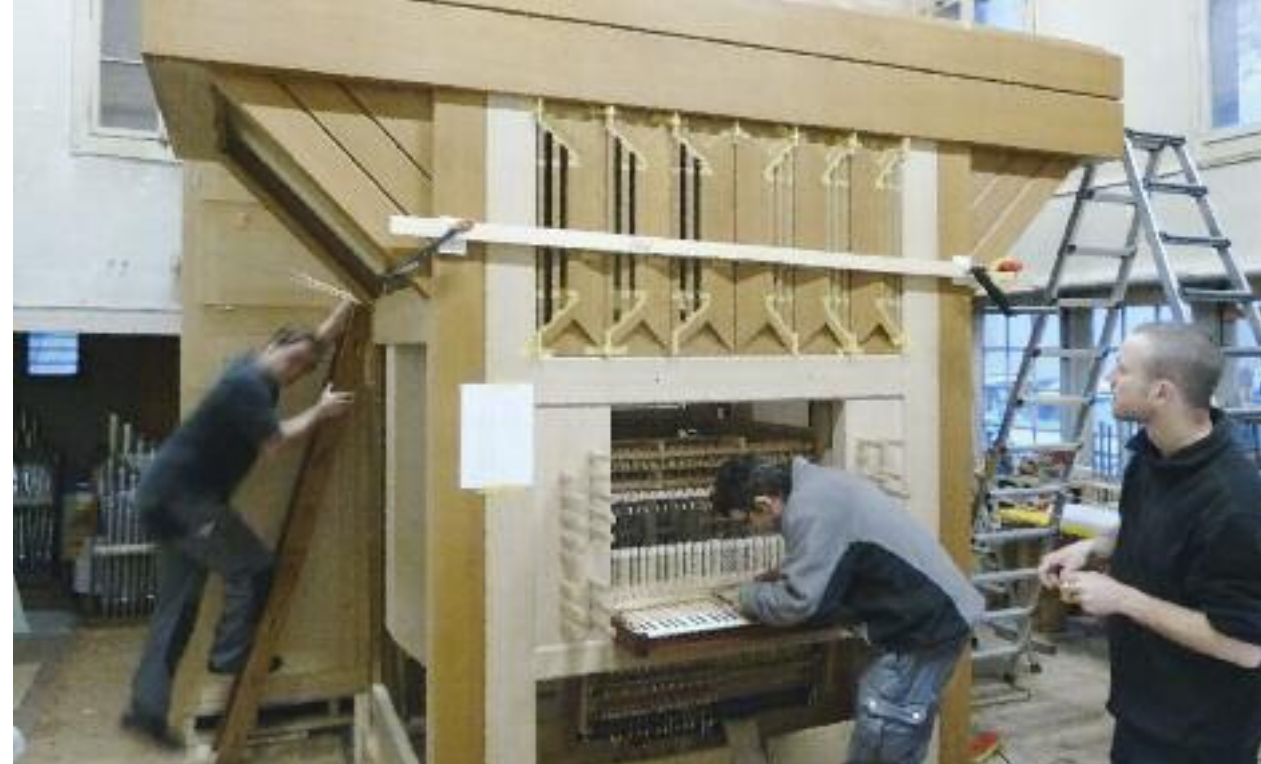
Vormontage des Unterbaus in der Werkstatt
